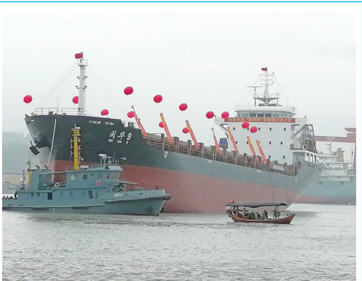
4月23日上午10时30分许,福安市赛江之滨,伴随着一阵汽笛声,一艘总长126米、载重量为12000吨的多用途货船——“闽华9”在20多个圆柱形橡胶气垫的助力下,从船台缓缓滑向赛江江面,成功下水。 据了解,该船由福建恒生船舶重工有限公司为厦门籍船东施工建造。船舶顺利下水后,将正式转入码头舾装和系泊试验阶段等。该船为柴油机驱动的多用途货船,具有球尾和垂直球鼻首线型,设双层底舱和边舱作为压载水舱,船总长126米、型宽20.8米、型深10.3米,设计吃水7.6米,入级中国船级社(CCS),适航无限航区。该船于2023年4月开工,预计2024年6月底完工并交付使用。 王平发 摄
