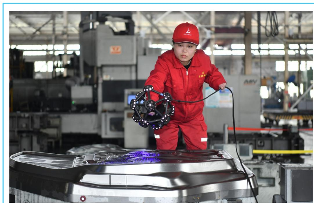
4月10日,泊头市金键模具有限责任公司技术人员在利用蓝光扫描仪检测汽车模具产品质量。近年来,冀中南老工业基地河北沧州泊头市围绕产业转型升级发展需要,坚持把科技创新作为推动经济发展的核心动力,通过推动自主创新,在创新创业平台提升、科技成果转化等方面取得长足发展。截至目前,泊头市已培育汽车模具、泵阀、绿色铸造等类型的科技型中小企业1300余家。
