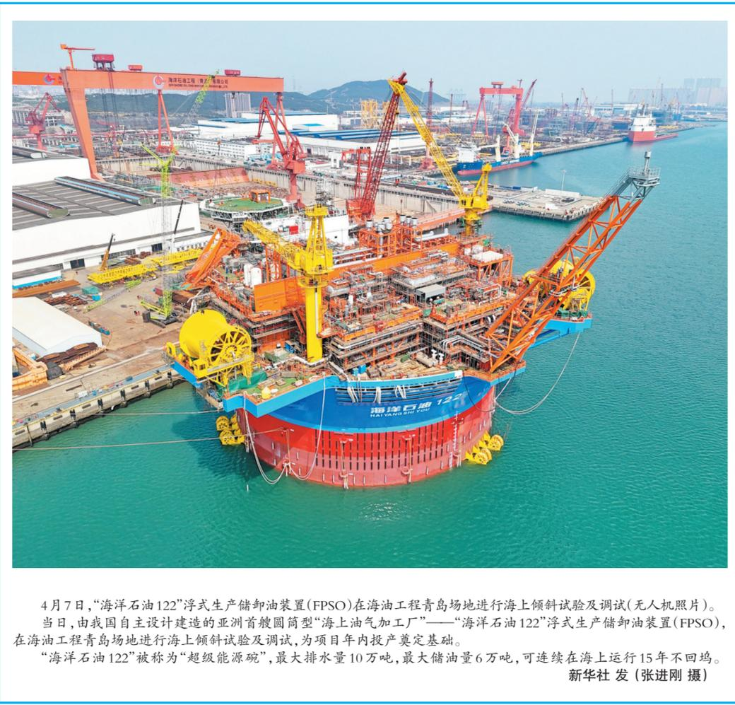
4月7日,“海洋石油122”浮式生产储卸油装置(FPSO)在海油工程青岛场地进行海上倾斜试验及调试(无人机照片)。当日,由我国自主设计建造的亚洲首艘圆筒型“海上油气加工厂”——“海洋石油122”浮式生产储卸油装置(FPSO),在海油工程青岛场地进行海上倾斜试验及调试,为项目年内投产奠定基础。“海洋石油122”被称为“超级能源碗”,最大排水量10万吨,最大储油量6万吨,可连续在海上运行15年不回坞。新华社发(张进刚摄)
