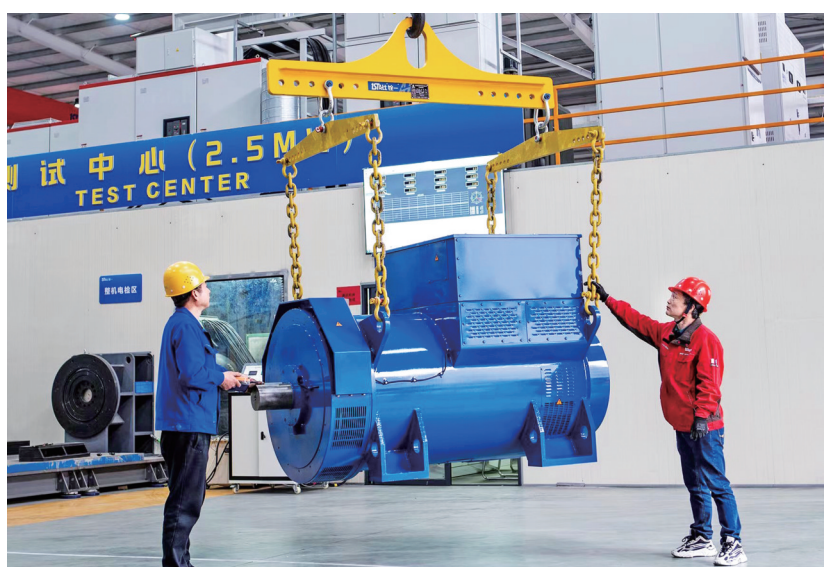
近日，位于福安市的福建建一电机首台10.5千伏高压无刷发电机正式下线，该电机适用于数据中心、矿山等需要高压直驱的应用场所，具有广阔的市场前景。据了解，该企业通过产品创新，春节后订单不断，3月产能有望创新高，实现“开门红”。 本报记者 张文奎 摄
