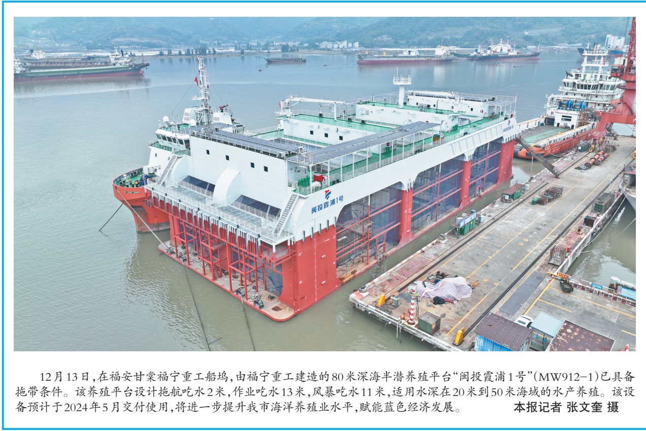
12月13日,在福安甘棠福宁重工船坞,由福宁重工建造的80米深海半潜养殖平台“闽霞霞浦1号”(MW912-1)已具备拖带条件。该养殖平台设计拖航吃水2米,作业吃水13米,风暴吃水11米,适用水深在20米到50米海域的水产养殖。该设备预计于2024年5月交付使用,将进一步提升我市海洋养殖业水平,赋能蓝色经济发展。 □ 本报记者 张文奎 摄
