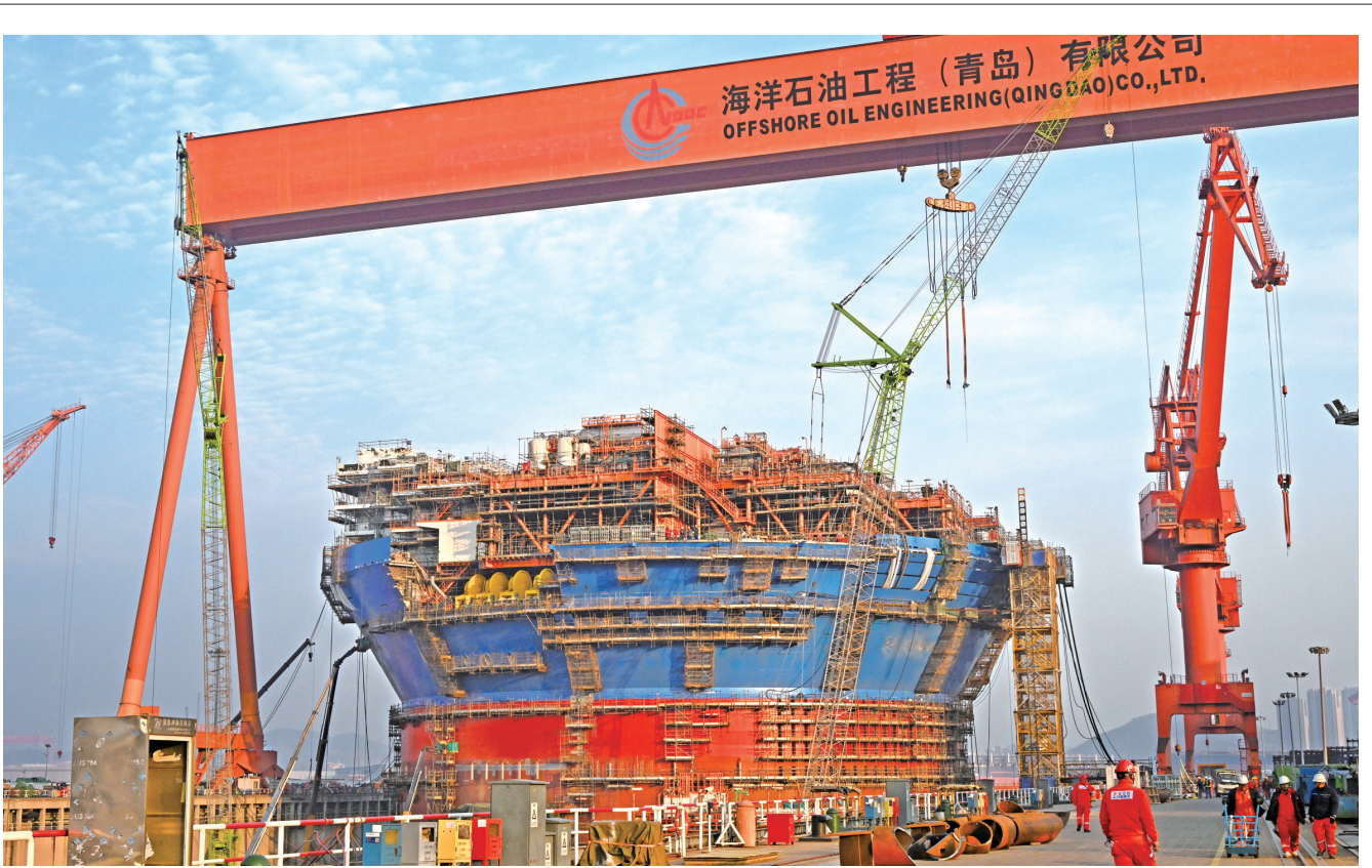
在海洋石油工程(青岛)有限公司生产基地,建造中的“海洋石油122”已显现雏形(12月4日摄)。近日,由我国自主设计建造的亚洲首艘圆筒型“海上油气加工厂”——“海洋石油122”浮式生产储卸油装置(FPSO),在青岛进入最后的总装集成冲刺阶段。据介绍,“海洋石油122”船体直径约90米,设计排水量10万吨,可连续海上作业15年不回坞。新华社记者 李紫恒 摄
