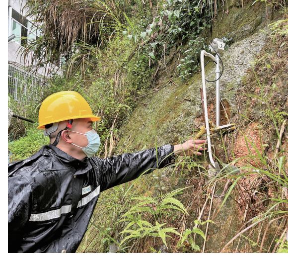
▲宁德移动为屏南59个地质灾害点建设的预警监控摄像头,提供实时监测预警服务
