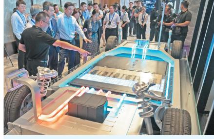
8月16日,参观者在观看宁德时代发布的神行超充电池 当日,宁德时代发布采用磷酸铁锂材料并可实现大规模量产的4C超充电 --神行超充电池,实现"充电10分钟,续航400公里"的超快充速度,并达 到700公里以上的绿航里程。 新华社记者 林善传 摄
